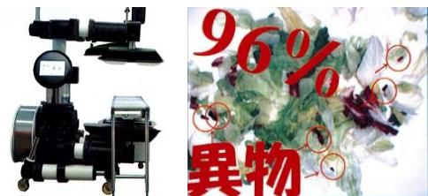
ベルトコンベアのLED照明で照らし出し異物を検出します。AIにより学習していく事で、日々検査精度が向上していきます。キャスター付きで移動もできます！
